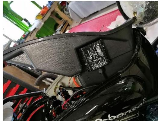
enlever le capuchon du contrôleur (rond vert) pour brancher les deux cosses noir et rouge sur les mêmes couleurs du contrôleur (rond bleu) ! **Avant de dévisser les deux vis du contrôleur, disjoncter le scooter et débrancher la batterie !** Puis refermer le capuchon et remonter tout.
